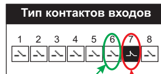
кнопка "Пуск", н.о. контакт кнопка "Стоп", н.з. контакт
