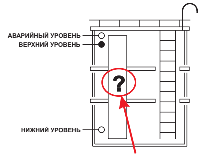
Неправильное срабатывание датчиков уровня
