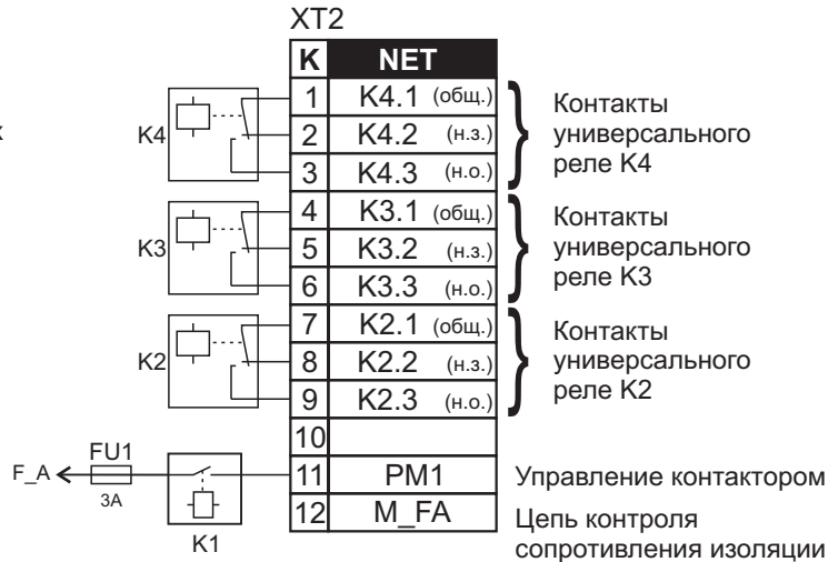
FU1 - предохранитель 3.15A 250В FU2 - предохранитель 0.5A 250В(внутри корпуса L4)
