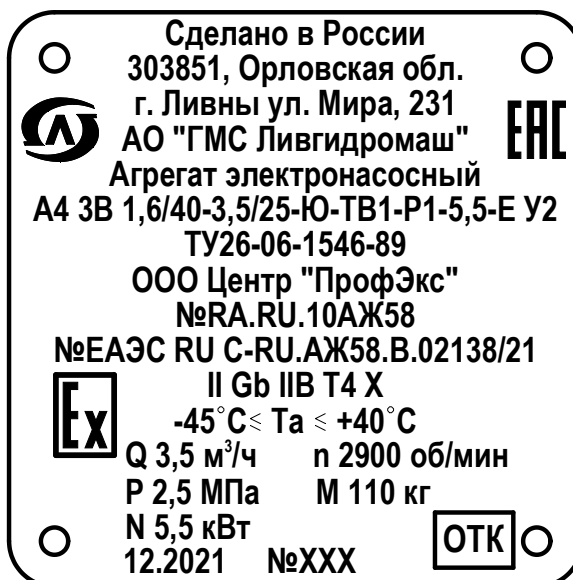
Рисунок 4 – Фирменная табличка (примеры оформления)
