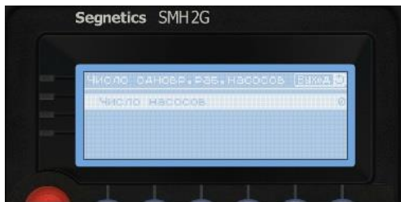
Рисунок 19. Экран “Число одновременно работающих насосов”
