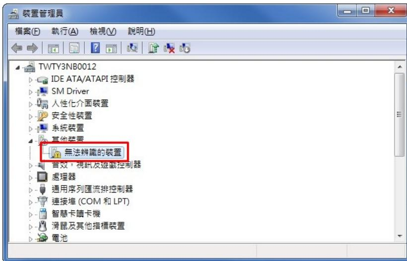
於裝置點擊滑鼠右鍵選擇【更新驅動程式軟體】開啟更新軟體頁面，點擊【瀏覽】指定驅動程式所在位置，指定完成後點擊下一步即開始安裝驅動程式。
