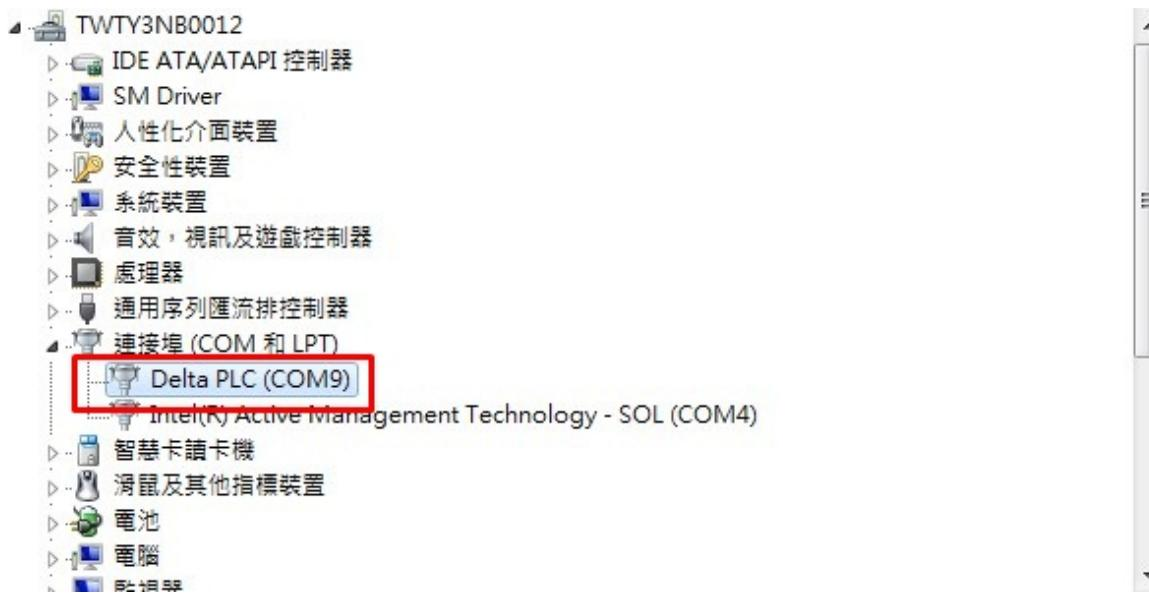
於目錄列【設定】選項中選取【通訊設定】開啓通訊設定頁面，在傳輸方式中選擇【RS232】，並指定通訊埠為 USB 所分派之 COM 口後按下【確定】。設定完成後可在通訊工作區中看到 RS232 被勾選。設定後即可透過 USB 對 DELTA PLC 進行程式上下載與線上模式。
