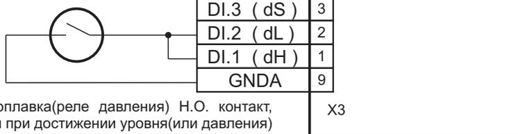
Если у поплавка (реле давления) Н.О. контакт, замыкающийся при достижении уровня (или давления) - функция станции: "Налив".
