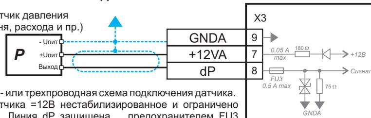
Возможна двух- или трехпроводная схема подключения датчика. Питание датчика =12В нестабилизированное и ограничено током ~60 мА. Линия dP защищена предохранителем FU3 номиналом до 0.5А (находится внутри корпуса L3).
